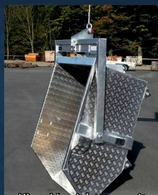
Kipp-Vorrichtung mit automatischer Ver- und Entriegelung
